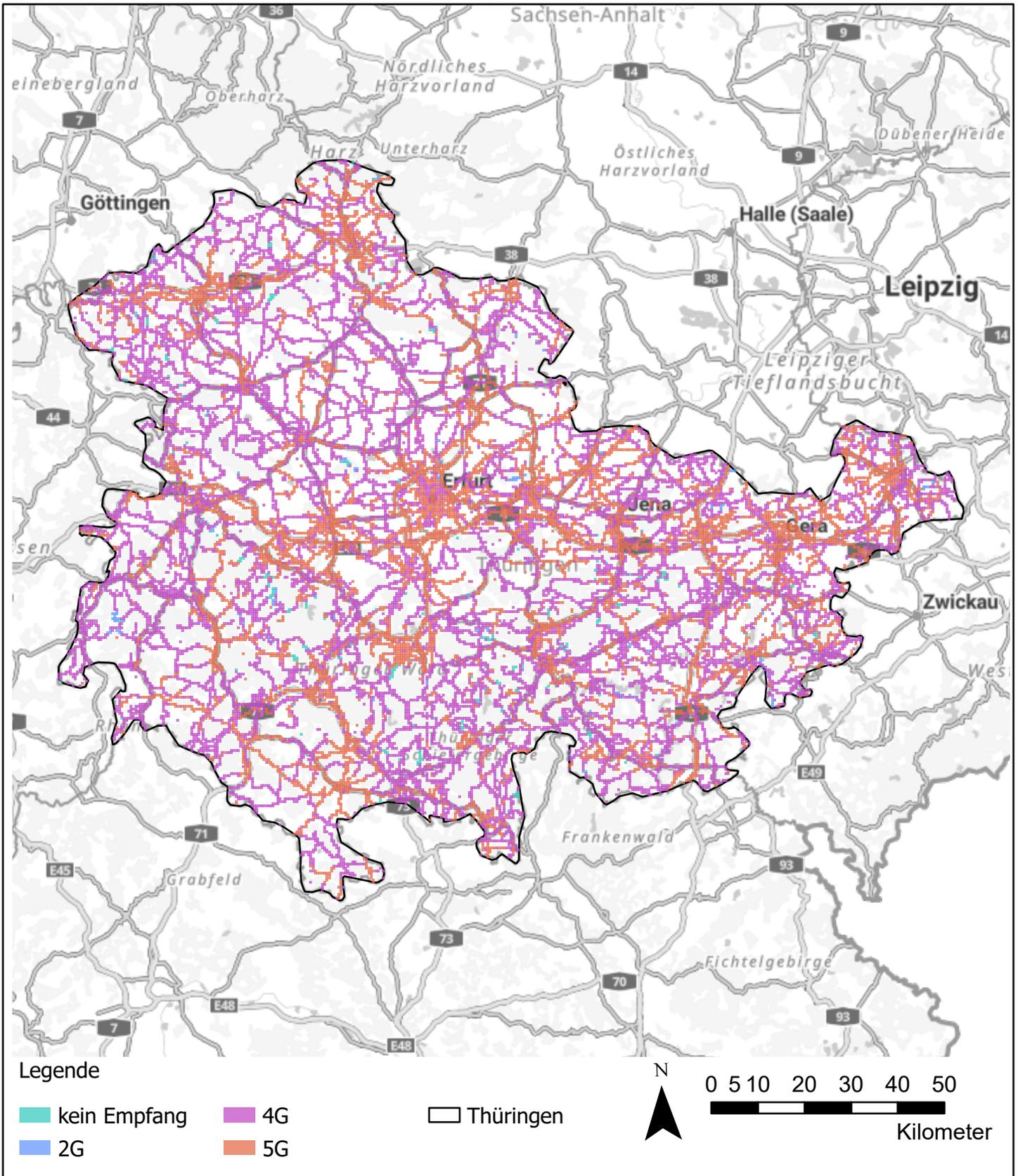
Die Karte zeigt die Messergebnisse der Breitbandmessung/Funkloch-App eines Bundeslandes, nach der mehrheitlich erfassten Technologie über alle Netzbetreiber in dem dargestellten 500 m Raster.
